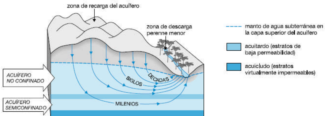
Figura 2.3: Régimen típico de caudal de agua freática y tiempos de residencia en regiones semiáridas (según Foster y Hirata, 1988)
